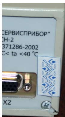
Рисунок 7 - Места пломбирования блока обработки влагомеров ВСН-2
